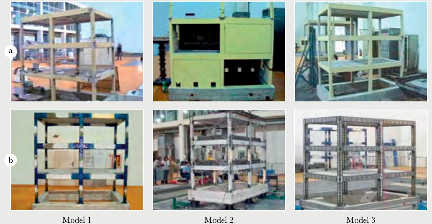
Figura 11. Progetto SICURO: a) modelli sperimentali della fase 1; b) modelli riparati/rinforzati nella fase 2 con confinamento FRP, con isolatori ADRI e con confinamento attivo e aggiunta di dissipazione.
