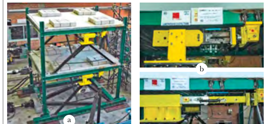
Figura 9. Modello sperimentale in acciaio con controventi dissipativi e particolare dei dispositivi di dissipazione di tipo isteretico e visco-ricentranti (Progetto JETPACS).
